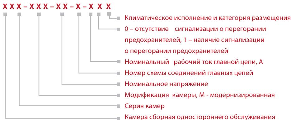
Камеры одностороннего обслуживания серии КСО 301М (в дальнейшем именуемые «камеры КСО») на номинальное напряжение 6 и 10 кВ, предназначенные для установки в распределительных устройствах трехфазного переменного тока частоты 50 Гц, для сетей с изолированной или заземленной через дугогасительный реактор нейтралью.
